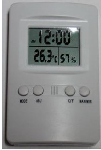
الشكل (7) جهاز Climeter لقياس حرارة الجو والرطوبة النسبية
