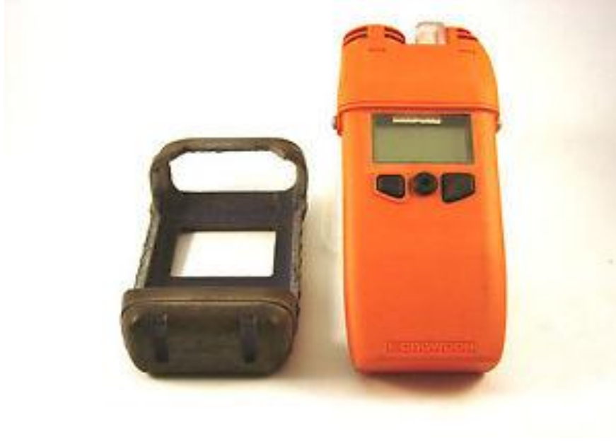
الشكل (5) جهاز Crowcon لقياس تركيز غاز سلفيد الهيدروجين
