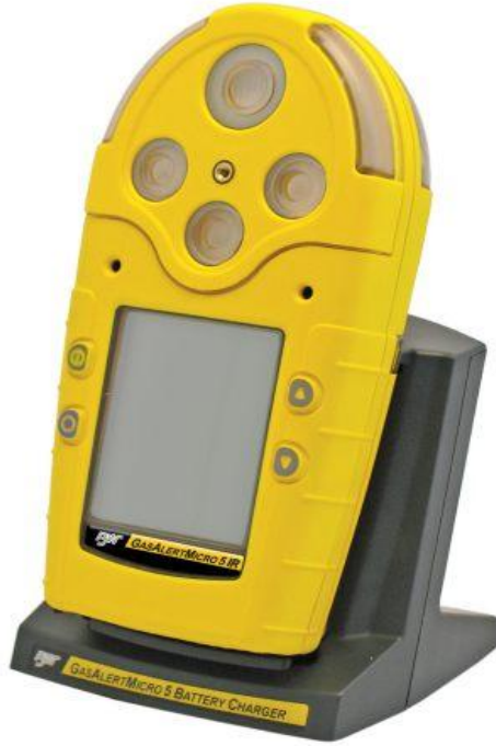
الشكل (6) جهاز BW لقياس تركيز غاز H 2 S
