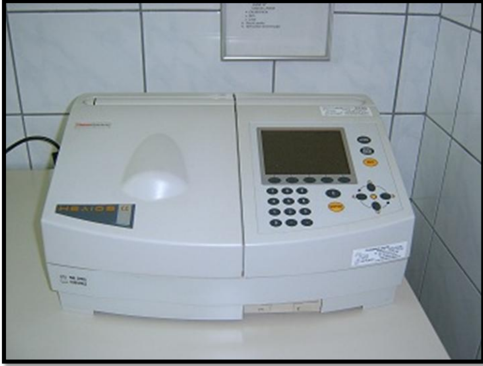
الشكل (9) جهاز المقياس الطيفي الضوئي من شركة Biocotek
